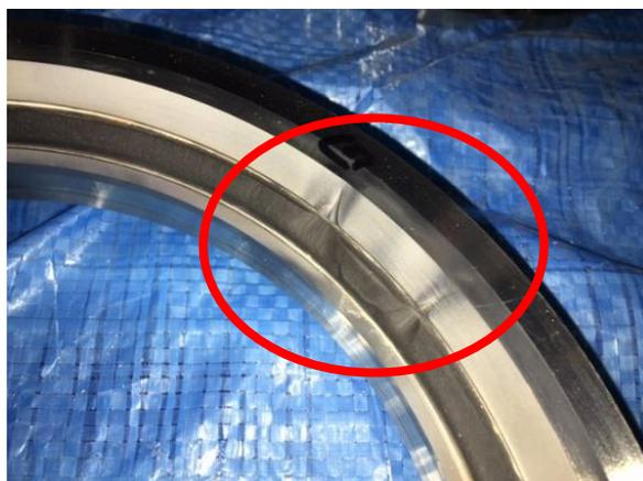
写真-5 下部灰拔出遮断機のシート面摩耗状況
