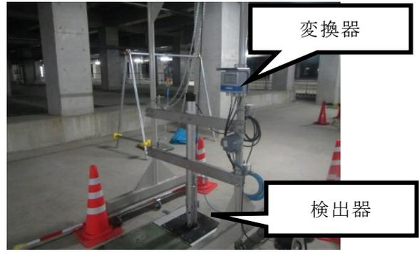
写真-1 アンモニアセンサー設置状況
