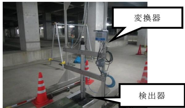
写真-1 センサー設置状況
